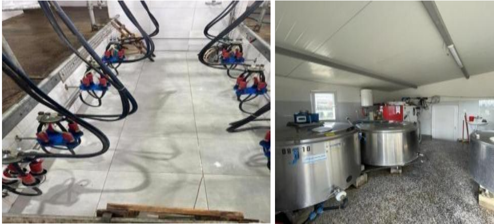
Foto 25, 26 | Foto: Muhamet Shala (2025, Kosovë) - Platforma e mjeljes dhe ruajtja e qumështit në tank
